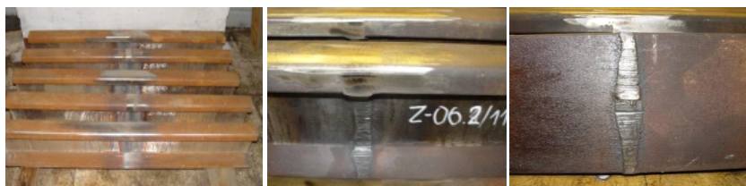
Rys 1. Złącza z szyn 60E1 zgrzanych metodą elektryczną, oporowo-iskrową, zgrzewarką torową
