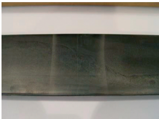
Rys. 8. Obraz makroskopowy główki złącza szynowego z widokiem osi złącza
