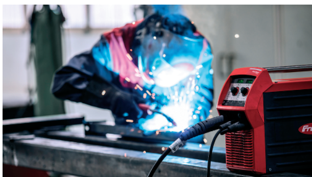
Fot. 5. Kompaktowe urządzenie TransSteel 2200 umożliwia spawanie metodą MAG, TIG i elektrodą otuloną
