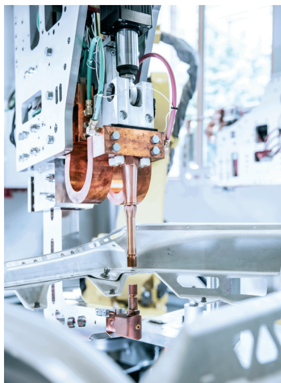
Fot. 8. Modułowe zgrzewadło DeltaCon zostało przystosowane do zgrzewania punktowego aluminium i zapewnia wysoką wydajność procesu
