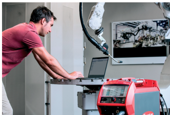
Fot. 2. Dzięki wbudowanym funkcjom w urządzeniu TPS/i, spawacz może korzystać z licznych odmian procesu MAG, takich jak LSC (Low Spatter Control), PMC (Pulse Multi Control) i CMT (Cold Metal Transfer)
