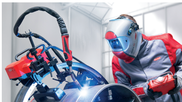
Fot. 6. Traktor spawalniczy FlexTrack 45 Pro zapewnia stałą prędkość spawania, a co za tym idzie, uzyskanie powtarzalnych wyników
