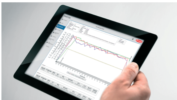
Fot. 1. WeldCube, system zarządzania danymi opracowany przez firmę Fronius, umożliwia pobieranie, analizę i prezentację danych o procesie spawania
