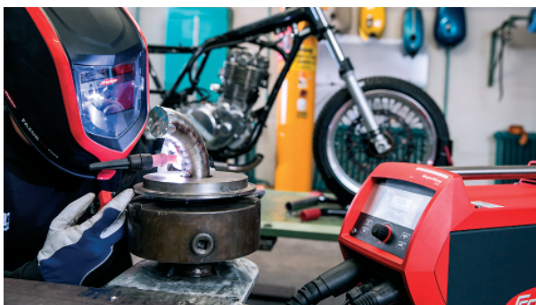
Fot. 4. MagicWave 230i to nowa generacja urządzeń do spawania metodą TIG, które oferują intuicyjną obsługę, powtarzalne zajarzenie łuku oraz dobre własności spawalnicze
