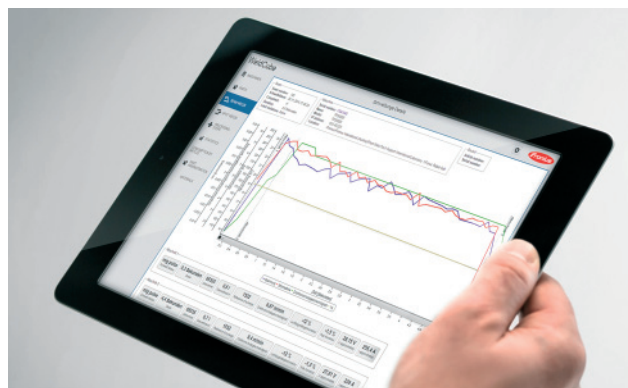
System dokumentacji i analizy danych WeldCube wizualizuje dane zarejestrowane przez źródło spawalnicze i prezentuje wyniki w przeglądarce internetowej
