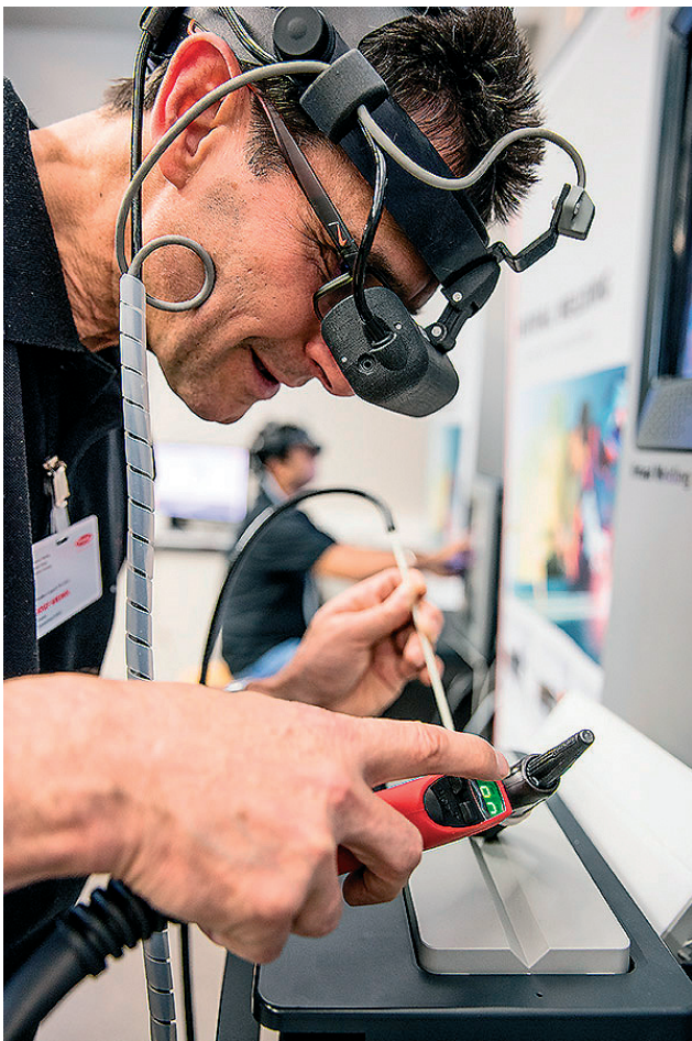
Symulator spawalniczy Virtual Welding umożliwia trenowanie różnych procesów spawania w sposób bliski rzeczywistości - bez konieczności stosowania drogich materiałów eksploatacyjnych i bez narażania zdrowia
