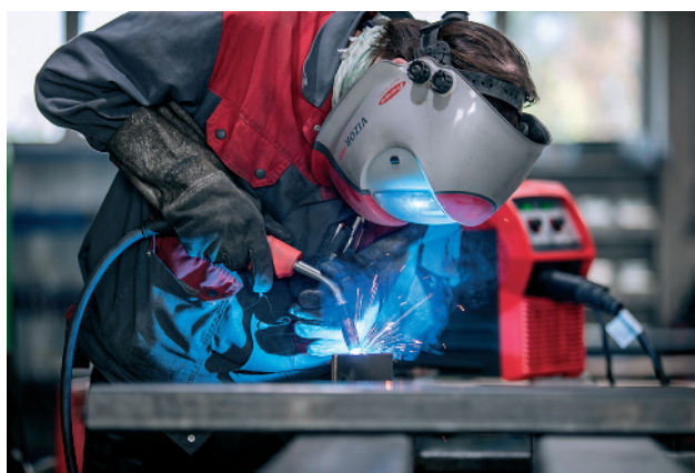
Urządzenia mają szeroki promień działania, ponieważ technologia PFC umożliwia stosowanie długich przewodów doprowadzających
