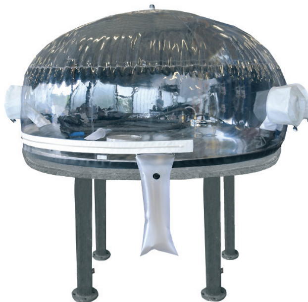
Rys. 2. Najskuteczniejszy sposób zapewnienia osłony gazowej o dużej czystości to zastosowanie elastycznych osłon. Dostępne są w rozmiarach do 30 m 3 i zapewniają bardzo niską zawartość tlenu na poziomie 10 ppm.
