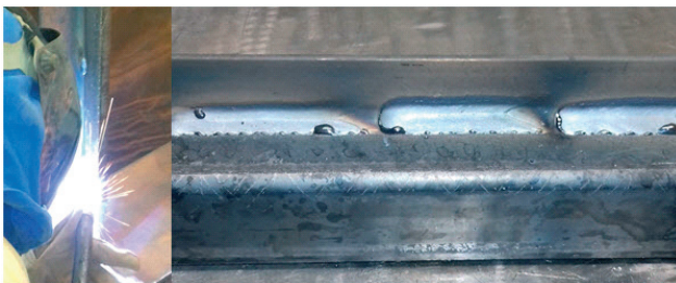
Rys. 3. Spoiny wykonane przez wytwórcę. Outershield MC710RF-H 1,2 mm.
