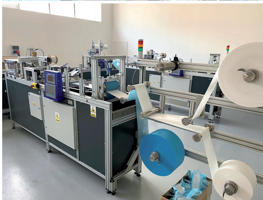
Rys. 3. Linia do automatycznego wytwarzania maseczek medycznych, wyprodukowana przez Łukasiewicz – ITR
