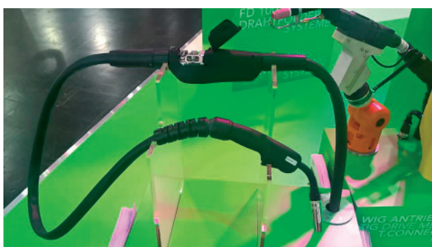
Rys. 5. System do spawania podwójnym drutem DIX MEDD TWIN za pomocą jednego źródła prądu DIX PI 600
