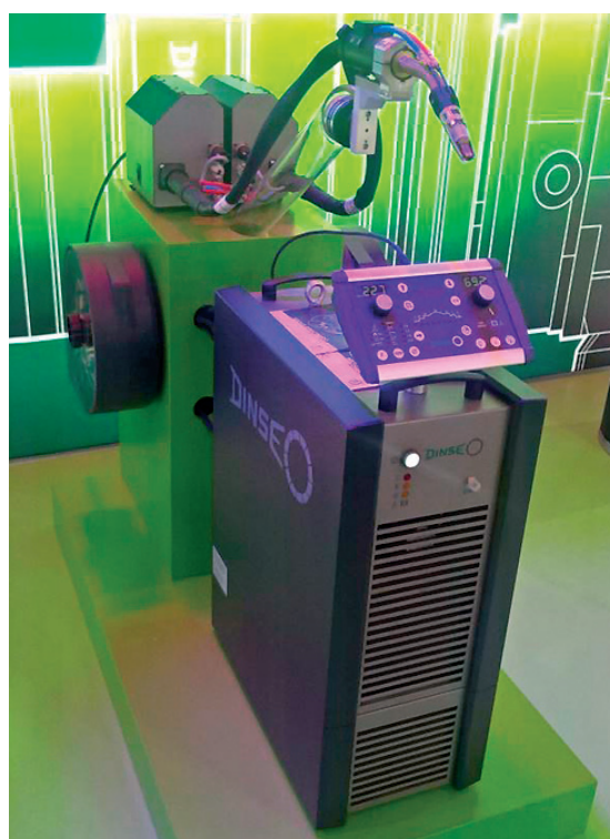
Rys. 5. System do spawania podwójnym drutem DIX MEDD TWIN za pomocą jednego źródła prądu DIX PI 600
