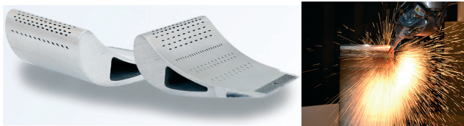
Rys. 3. Otwory wykonane laserem QCW: strona lewa - łopatki turbiny z otworami wykonanymi za pomocą lasera typu QCW; strona prawa - proces wykonywania otworów w komorze spalania silnika za pomocą lasera YLS-900-9000-QCW; (źródło IPG)
