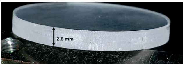
Rys. 4. Szkło szafirowe o grubości 2,8 mm wycięte z prędkością 3 mm/s
