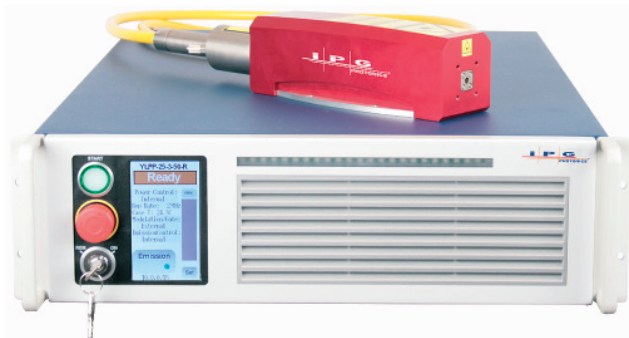
Rys. 1. Nowy laser YLPP typu UKP; parametry: czas impulsu 2-3 pikosekundy, energia impulsu rzędu 25 \mu J, moc średnia 50 W
