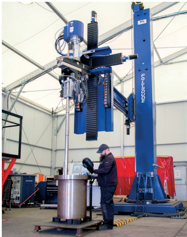
Rys. 11. Napawanie powierzchni wewnętrznej tulei, stanowiących elementy końcówek przewodów elastycznych
