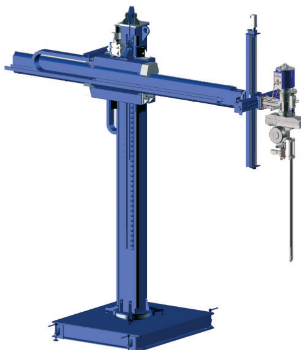
Rys. 5. Słupowysięgnik do napawania z dodatkowymi przewodnikami, zapewniającymi odpowiedni zakres ruchu
