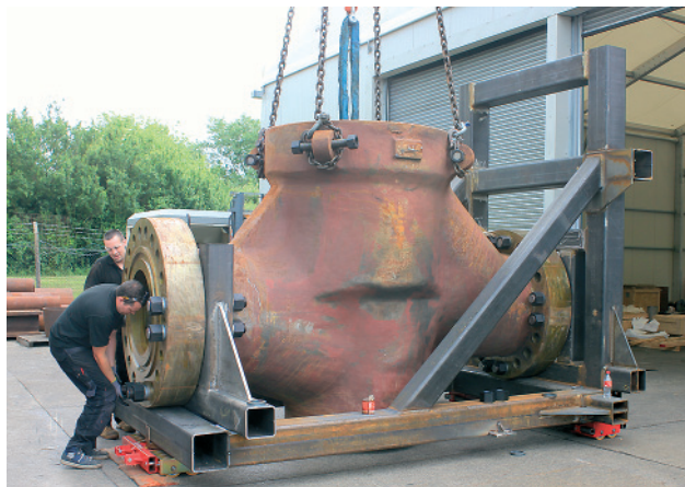
Rys. 3. Zawór (odlew) o masie 27 ton
