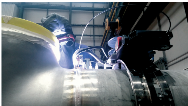
Rys. 5. Przykład procesu spawania orbitalnego w przemyśle wydobywczym ropy i gazu ziemnego, zapewniającego spoiny wolne od niezgodności spawalniczych
