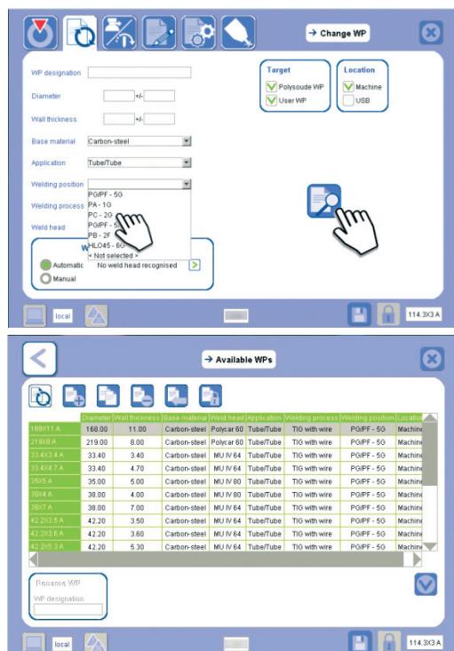
Rys. 2. Użytkownik wprowadza podstawowe informacje za pomocą ekranu dotykowego I wybiera odpowiednią WPS z wbudowanej bazy danych
