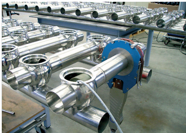
Rys. 4. Głowice zamknięte zapewniają spełnienie wymagań odnośnie czystości złączy
